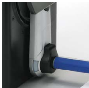
Farbige LEDs zur Statusanzeige des Aufwicklers
